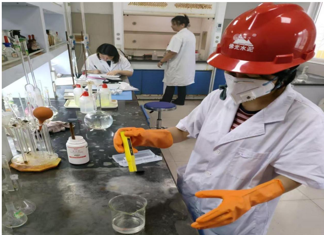
对应急池取出的水样进行 PH 化验，数据达标，认定应急处置有效
